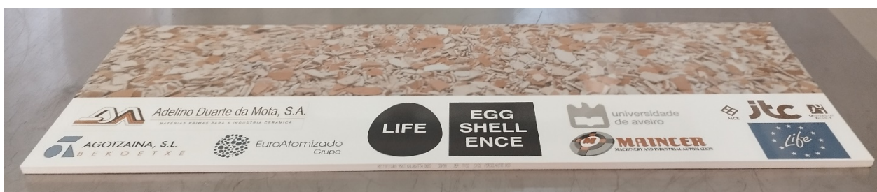
Figura 5. Baldosa de azulejo obtenida industrialmente con la composición con un 5% de bio-carbonato.
